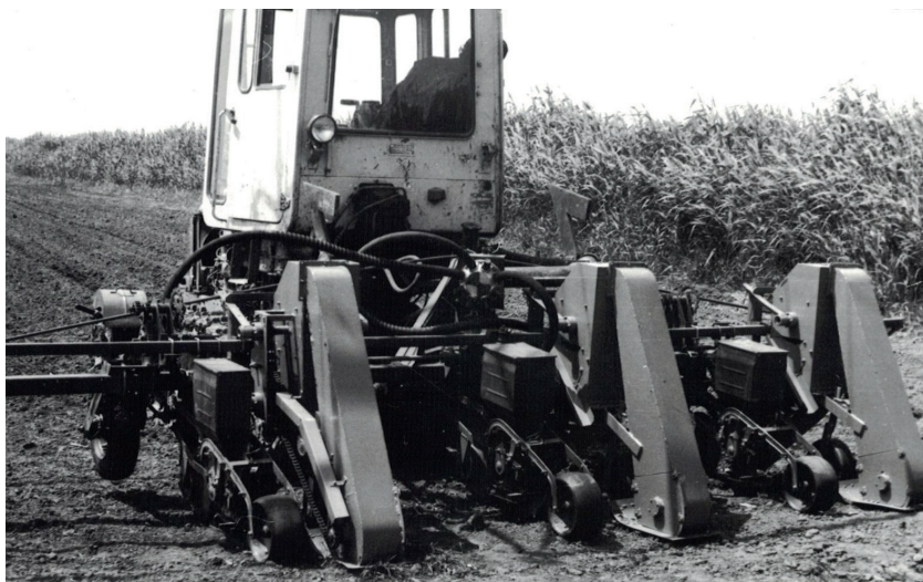
Разработанная Н. Е. Руденко сеялка, обеспечивающая повреждение семян сорняков в зоне рядков одновременно с посевом, не имеющая мировых аналогов, 1991 г.
